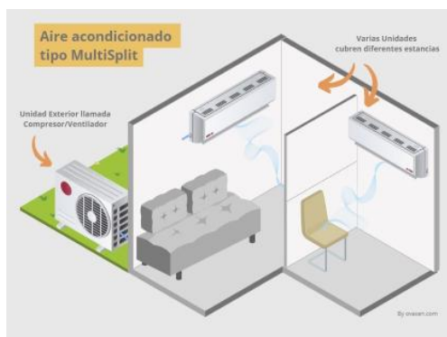
Figura 2. Aire acondicionado multisplit . (Seguí, s.f.)
