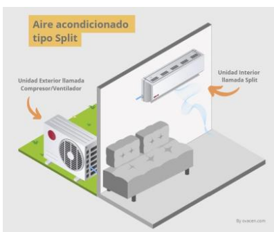
Figura 1. Aire acondicionado split . (Seguí, s.f.)
