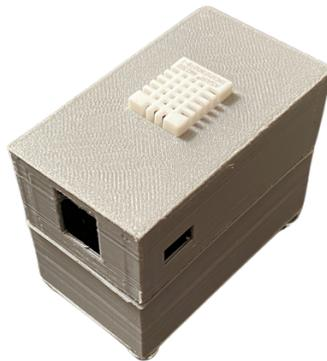
Figura 67. Implementación de pruebas de rendimiento del modelo 3D del dispositivo sensor con espacio adicional para batería de 3,7V.
