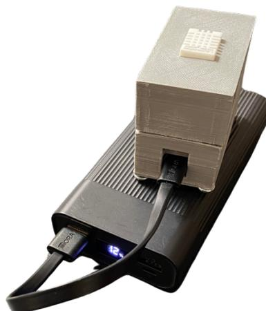
Figura 68. Implementación de pruebas de rendimiento del modelo 3D del dispositivo sensor con batería externa de 20,000mAh.
