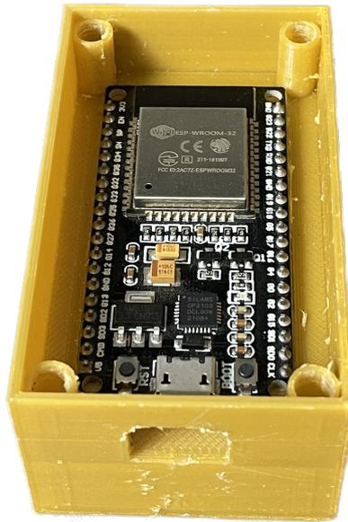
Figura 14. Modelo impreso en 3D de la carcasa del dispositivo sensor (Interior).
