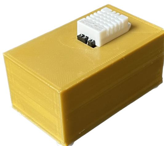
Figura 13. Modelo impreso en 3D de la carcasa del dispositivo sensor
