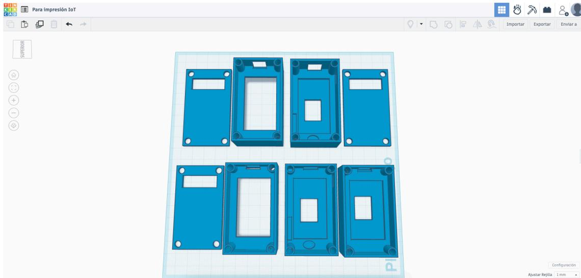
Figura 66. Modificación del diseño integrando batería de 3,7V.
