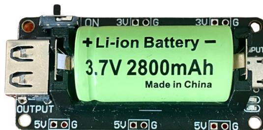
Figura 64. Batería de Li-ion que opera a 3.7V con una capacidad de 2,800mAh.
