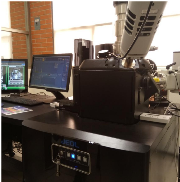
Figura 7. Imagen del microscopio JEOL JSM – IT 300 y el EDS acoplado UAEH.
