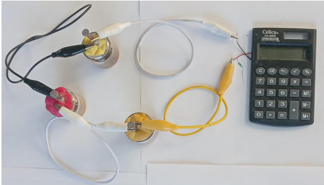
Figura 43. Imagen de la batería C conectada a una calculadora sencilla.
