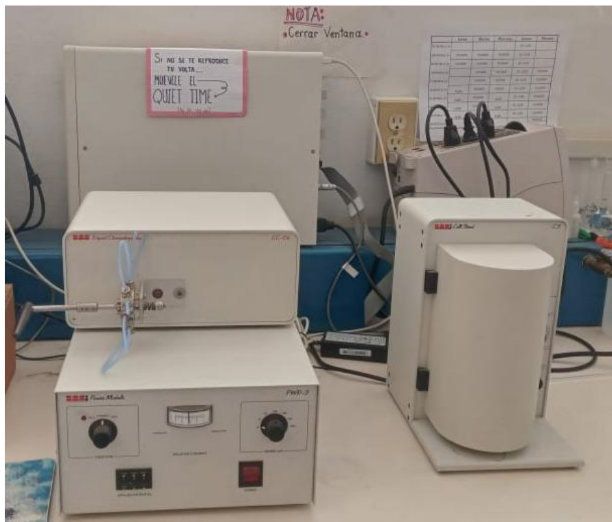
Figura 9. Potenciostato Epsilon EC UAEH.
