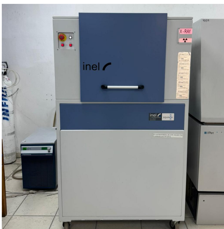
Figura 6. Imagen difractor INEL modelo equinox 2000 UAEH.
