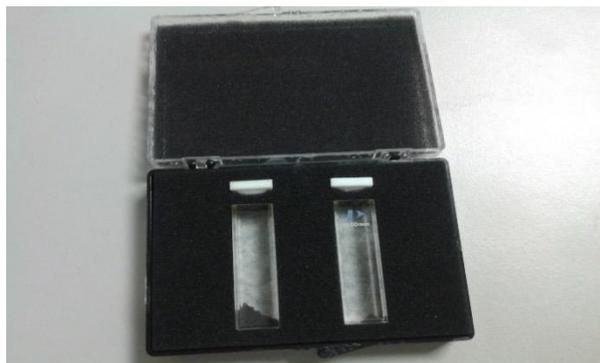
**Figura 3.16.** Celdas de cuarzo que se utilizan como referencia.
