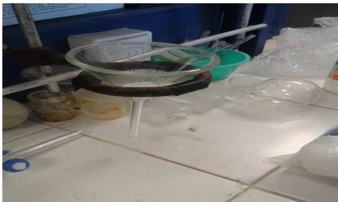
**Figura 3.4.** Proceso de filtrado falta decir de filtrado del compuesto OIC2MS utilizando sulfato de sodio.
