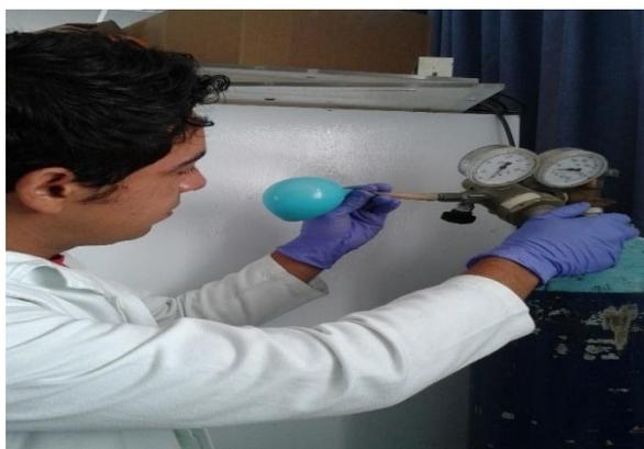
**Figura 3.9.** Llenado de globo con argón para ambiente inerte.
