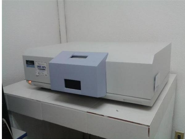
**Figura 3.19.** Espectrómetro de fluorescencia Perkin Elmer LS 55.
