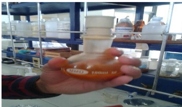
**Figura 3.6.** Precipitación del compuesto con hexano.
