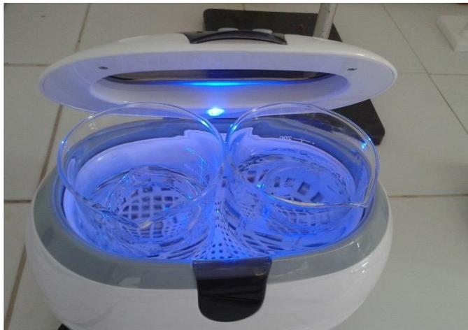
**Figura 3.24.** Equipo de ultrasonido para el lavado de sustratos.
