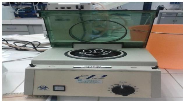
**Figura 3.7** Máquina de centrifugado para separar el hexano del compuesto.
