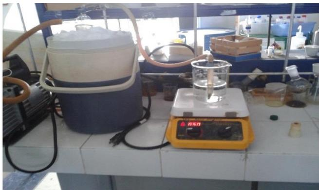
**Figura 3.8.** Extracción de hexano con baño María y bomba de vacío.
