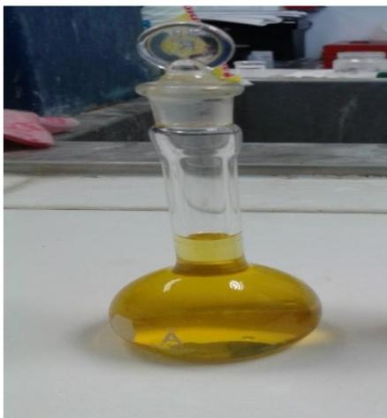
**Figura 3.13.** Matraz aforado con disolvente a una cantidad de 25ml.
