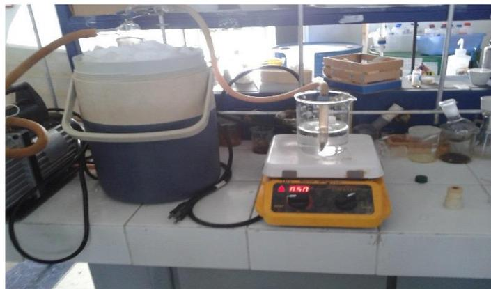
**Figura 3.12.** Extracción de hexano utilizando bomba de vacío del compuesto OIC5C.
