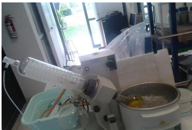
**Figura 3.11.** Rotavapor para la extracción del disolvente tolueno del compuesto OIC5C.
