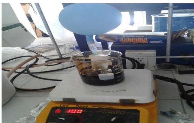
**Figura 3.10.** Reacción a reflujo de los compuestos sintetizados por ruta convencional.
