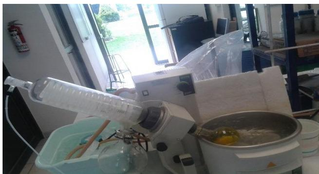
**Figura 3.5.** Rotavapor para retirar el disolvente del compuesto OIC2MS utilizando diclorometano como disolvente.
