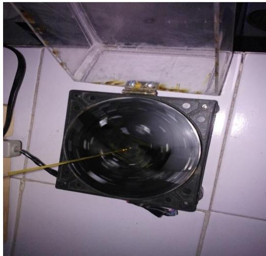
**Figura 3.25.-** Depósito de compuesto en Spin Coating
