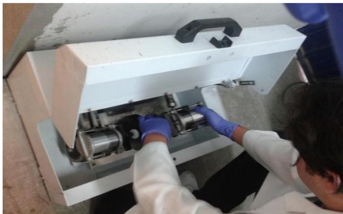
**Figura 3.2.** Molino de alta frecuencia Spex 800D.
