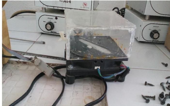
**Figura 2.22.** Estructura de depósito con ventilador de computadora.
