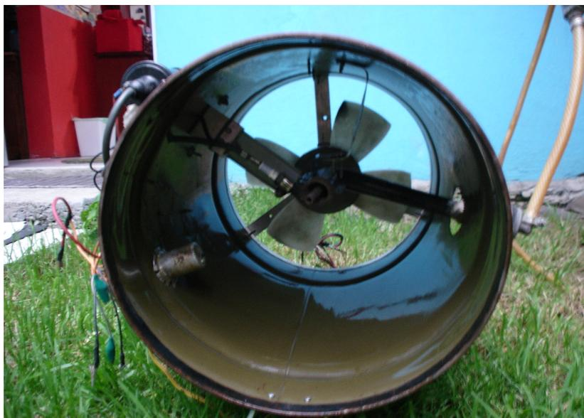
Figura B.3: Ventilador, Sensor de Flama y Bujía
