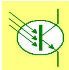
Figura 3.14: Diagrama de un Fototransistor NPN
