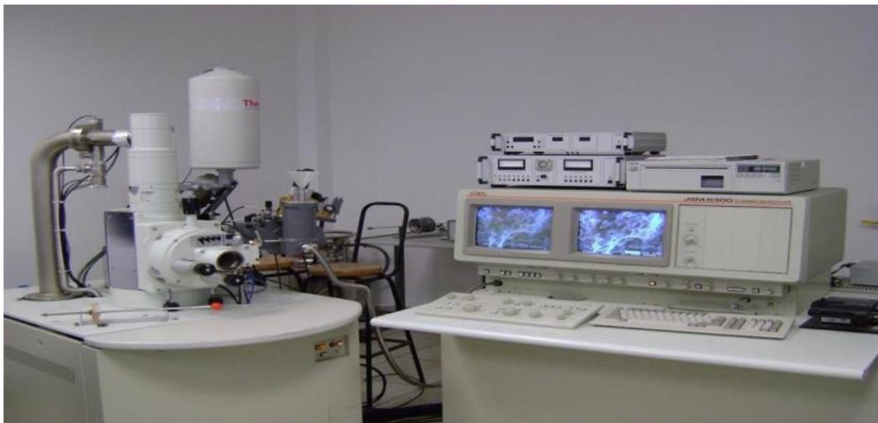
**Ilustración 3.** Microscopio JEOL JSM-IT300, equipado con detector EDS.
