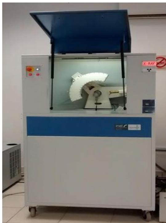
***Ilustración 2.*** Difractómetro marca Inel, modelo Equinox 2000.
