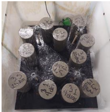
Figura 3.4. Sistema de aspersión para curado húmedo
