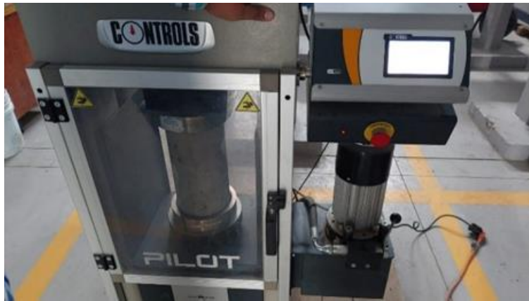
Figura 3.6. Ensayo de resistencia a compresión en prensa hidráulica
