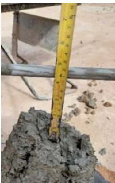
Figura 3.3. Ensayo de revenimiento
