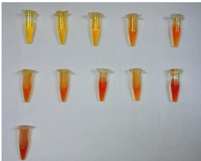
Figura A1 Determinación de azúcares reductores en ingredientes para formular medios de cultivo.
