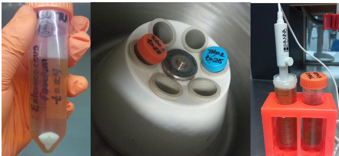
Figura 2 Separación de biomasa y neutralización de sobrenadante libre de células
