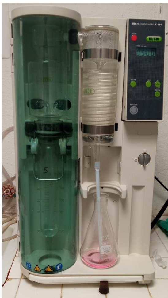
Figura A4 Determinación de N en ingredientes para formulación de medios
