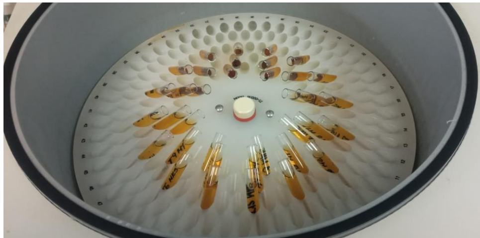
Figura 14 Concentrados en SpeedVac de SLC para posterior determinación de proteína en NanoDrop.
