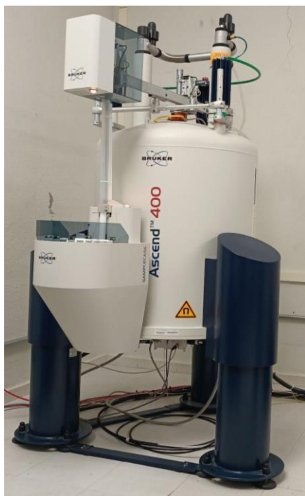
Figura 12. Equipo de Resonancia Magnética Nuclear Bruker® Ascend 400 en donde fueron analizadas las muestras AME-5 y 104 en el Área Académica de Química en la Universidad Autónoma del Estado de Hidalgo.
