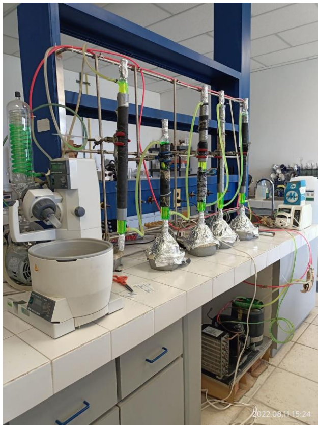
Figura 11. Sistema completo que permite la extracción de la materia orgánica soluble en función de la técnica de Extracción Secuencial Termorregulada de Flores Castro et al. (2011). Fotografía tomada durante el proceso de extracción por Severiano Osorio Andrade el día 11 de agosto del 2022.
