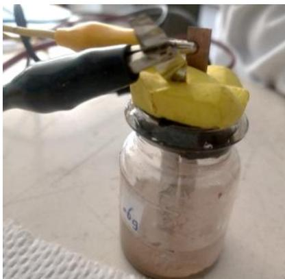
**Figura 15.** Diseño para optimizar la concentración entre el residuo industrial minero y el agua desionizada.
