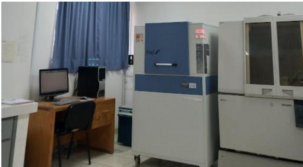
**Figura 4.** Difractómetro de rayos X marca INEL, modelo EQUINOX 2000
