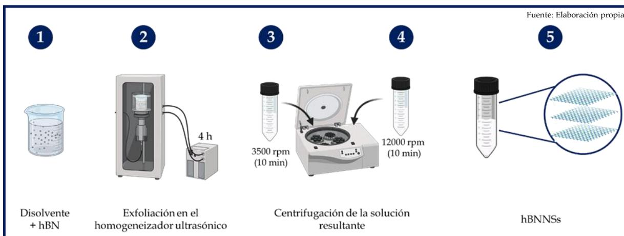
*Figura 2.1. Representación esquemática de la exfoliación de hBN mediante el método de exfoliación en fase líquida para obtener hBNNSs.*
