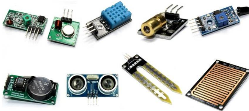
**Figura 4.** Diferentes sensores utilizados en el IoT. Se presentan diversos sensores, incluyendo el sensor ultrasónico, que emite señales para medir distancias con precisión, y el sensor de humedad, uno de los más utilizados en aplicaciones de monitoreo ambiental y de fluidos. Fuente: (Electronics, s.f.)
