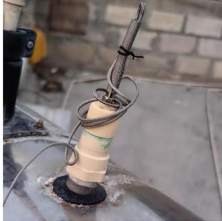
**Figura 33.** Sensor termopar tipo K colocado en la válvula de lavado
