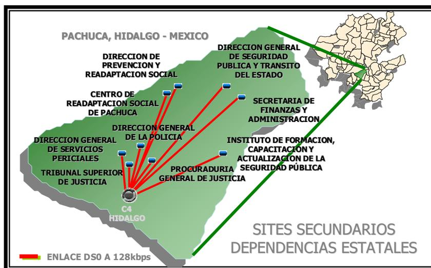
FIG. 2.16 ESQUEMA BASICO DE LA RED DE TRANSPORTE Y ADMINISTRACIÓN DE SISTEMAS
