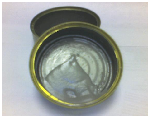
figura 15 mezcla del mineral con aceite de linaza dentro de una lata de acero.
