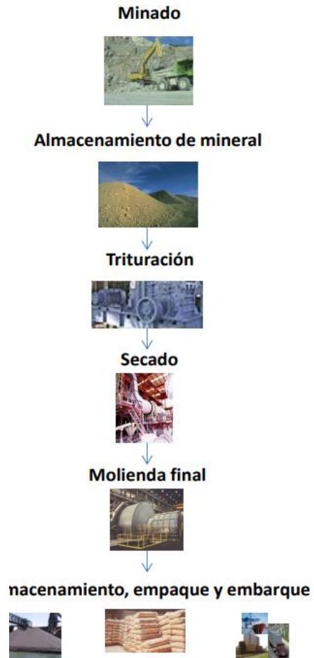
Figura 11 Proceso de extracción de bentonita.
