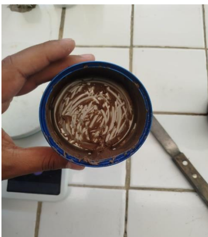
figura 18 pasta de bentonita resultado con la mezcla de aceite de linaza
