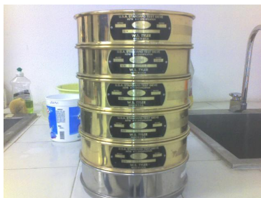
Figura 21 Juego de tamices utilizados para el análisis de tamaño de partícula.
