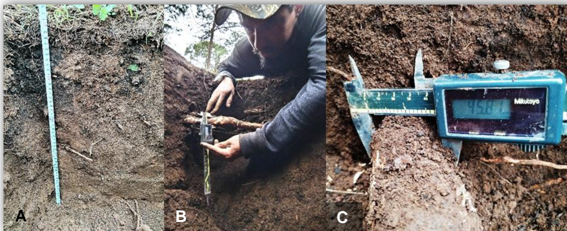
Figura 17. Perfil de suelo. Raíces en el perfil (A), Medición del diámetro de raíz (B), Lectura del diámetro con el vernier (C)
