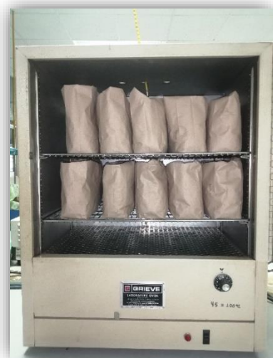
Figura 12. Muestras de suelo en estufa para obtener el peso seco constante.
