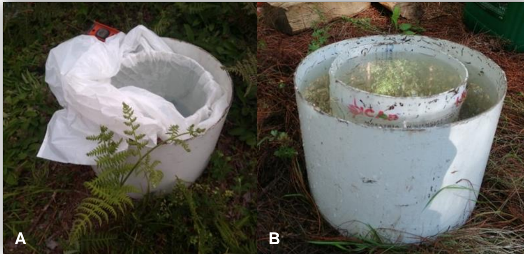
Figura 10. Funcionamiento del infiltrómetro de doble anillo. Aforamiento del anillo interno (A) , Relleno de ambos anillos e inicio de la prueba (B)
