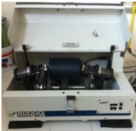
*Figura 3. 3 - Molino de alta energía SPEX Mixer/Mill mod 8000D.*
