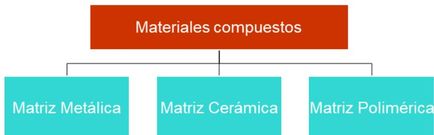
Figura 1. Clasificación de materiales compuestos.
