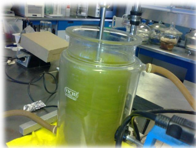
Figura 12 Dispositivo de extracción de polisacáridos pécticos, compuesto de un tanque encaquetado de vidrio, un agitador Lighnin® con control de velocidad y monitoreo de temperatura.
