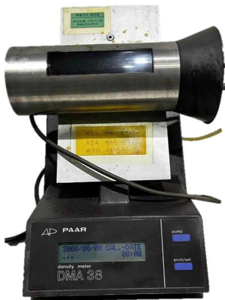
Figura 13 Densímetro digital modelo DMA-38 marca Anton Paar.
