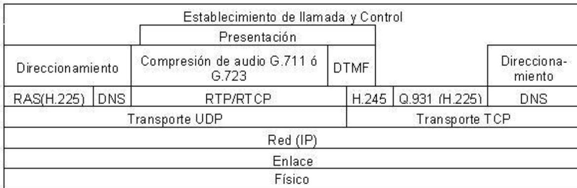
Figura 2.3: Pila de protocolos en VoIP.
