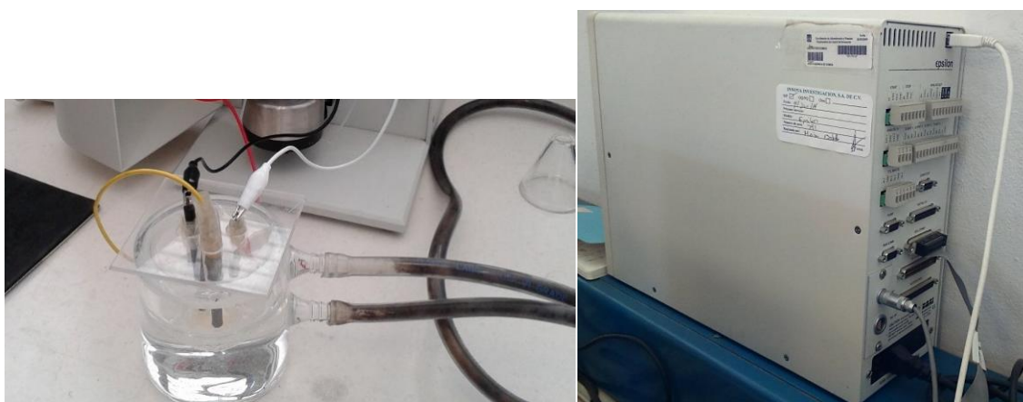
Figura 3.3 Celda electroquímica utilizada, potenciostato EPSILON (Software de BASI EPSILON EC)
