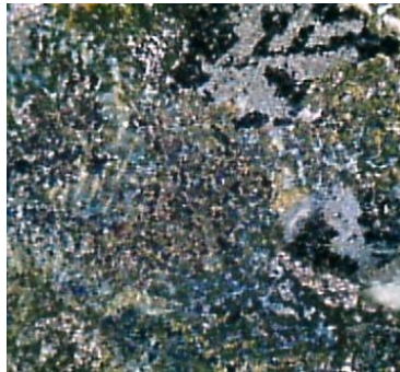
Figura 5.8.1 Microscopia de un depósito de cobre obtenidos sobre un electrodo de carbón vítreo de 1mm x 1mm a 400X y un potencial de inversión de -0.4 V.
