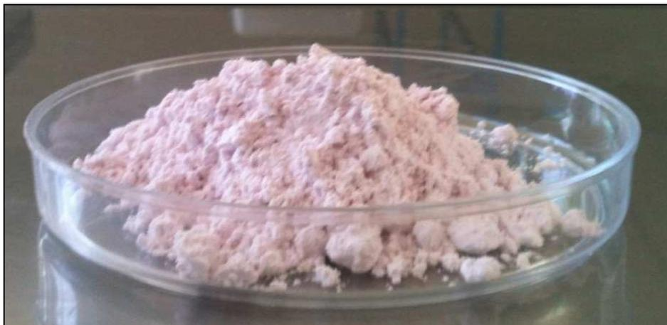
**Figura 5.** Polvo fino obtenido mediante secado por aspersión: MJGR (Obtenido el 25 de octubre de 2012, 20 gramos).
