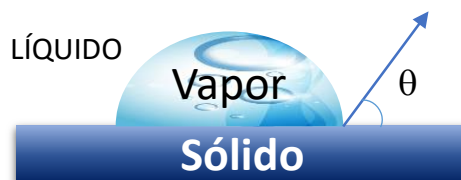
Figura 5 Ángulo de contacto de un sólido con la burbuja.
