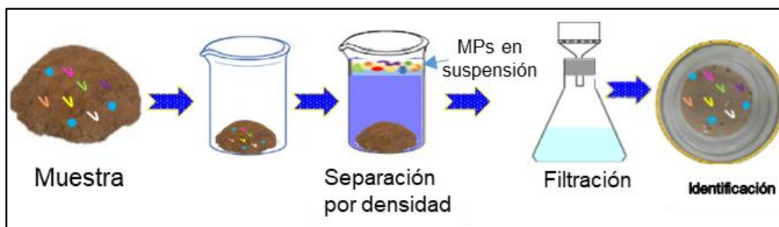
Figura 6. Método de separación de microplásticos de sedimentos Modificado de Nabi et al., (2022).
