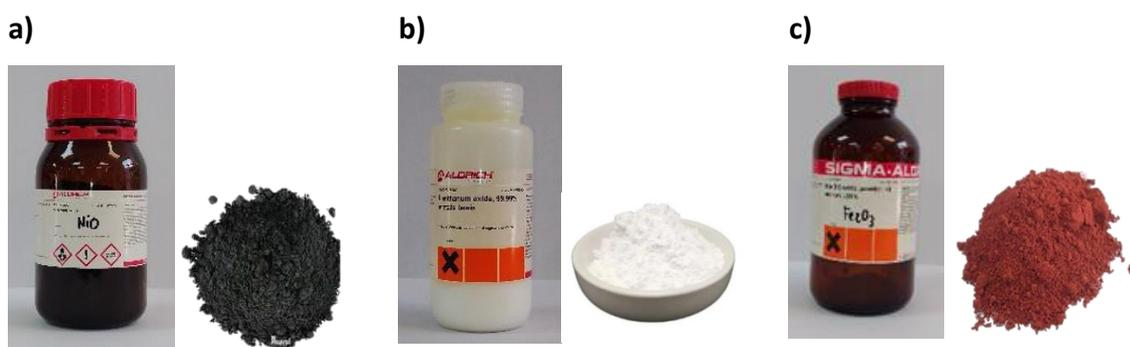
**Figura 4.1** Macrofoto de polvos de partida (precursores): (a)  $\text{NiO}$ , (b)  $\text{La}_2\text{O}_3$  y (c)  $\text{Fe}_2\text{O}_3$
