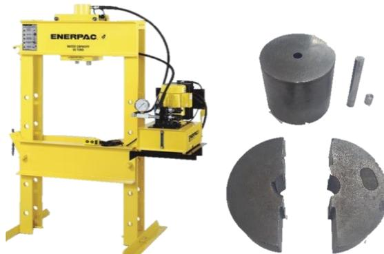
**Figura 3.3** Prensa hidráulica y conjunto matriz-punzón para obtención de pellets
