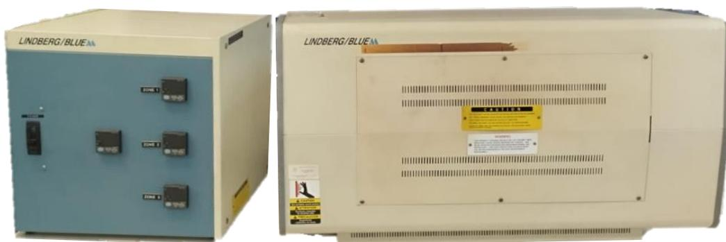
**Figura 3.4.** Horno de tubo para la sinterización de compactos o pellets
