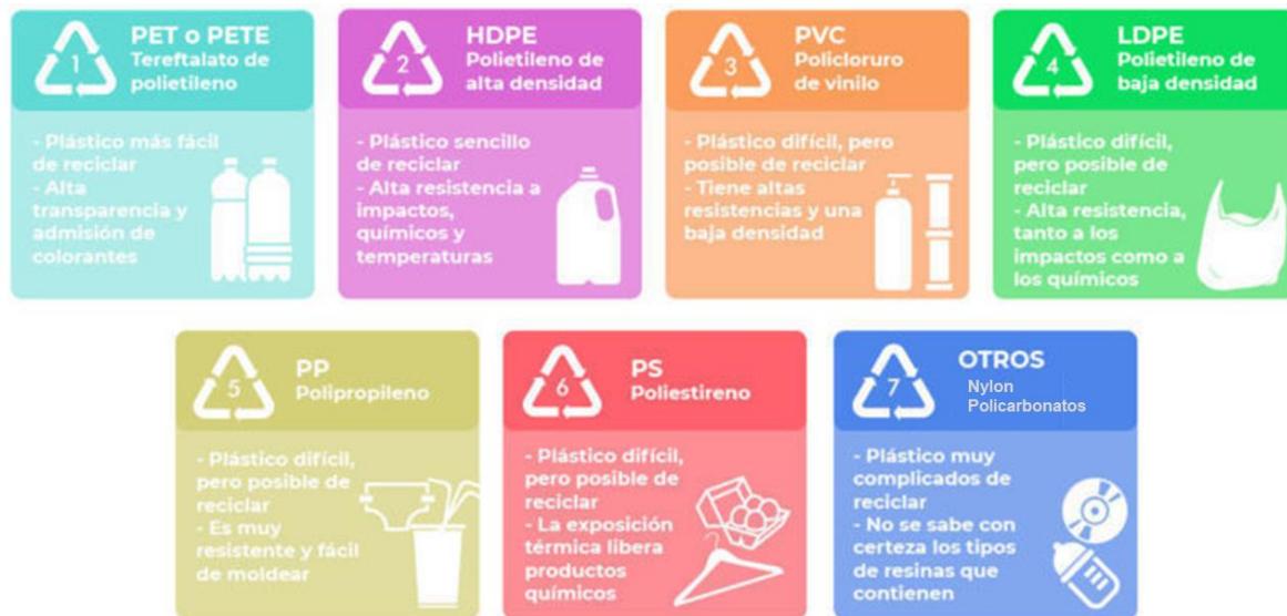
Figura 8. Códigos de reciclado para separación de plásticos de acuerdo con la ASTM.
