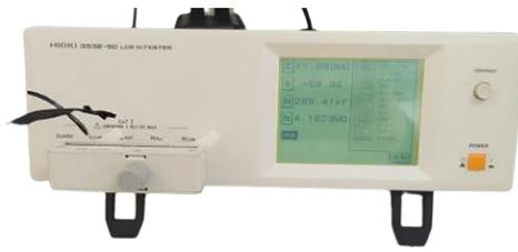
**Figura 16** Equipo LCR (Inductancia (L), Capacitancia (C) y Resistencia (R))
