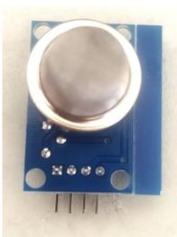
Figura A.4: Sensor de hidrógeno *MQ-8*.
