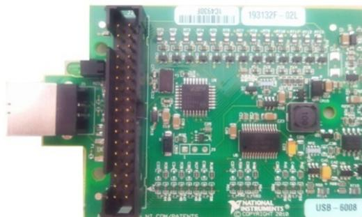
Figura A.7: Tarjeta de adquisición *MyRio6008 OEM*.
