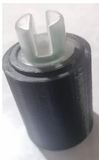
Figura A.1: Sensor de turbidez *TS300B*.
