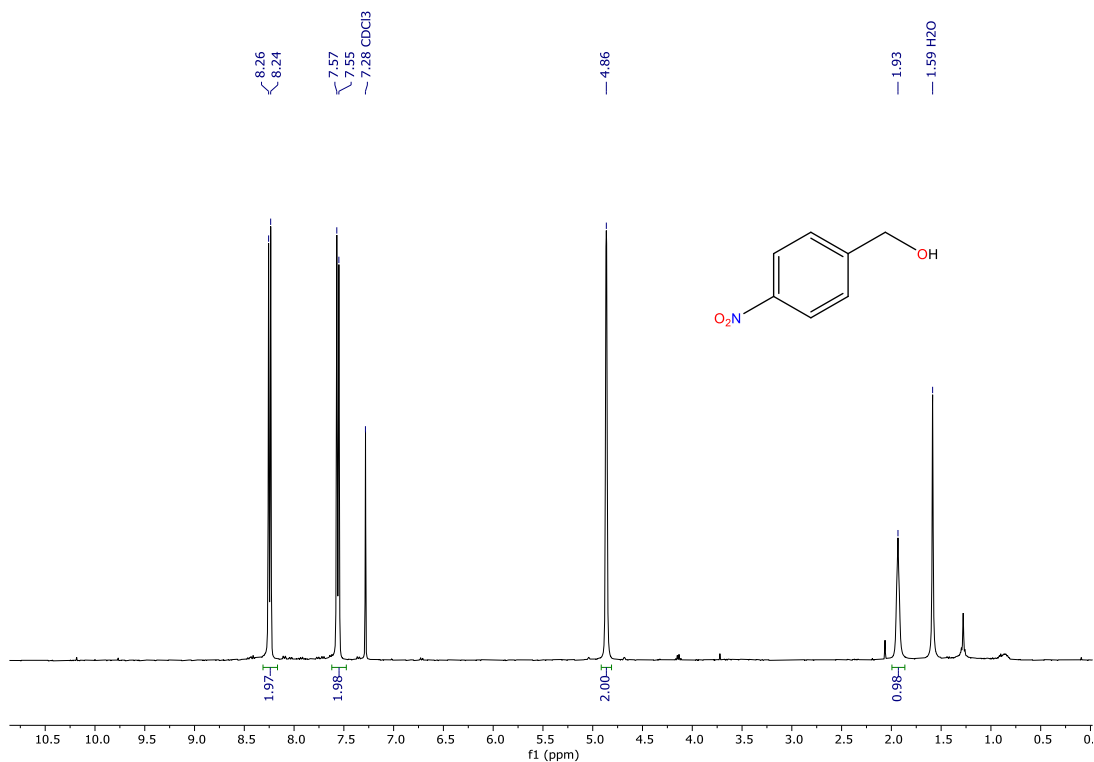
Figura 62. Espectro de RMN de ^1\text{H} (400 MHz) del 4-nitrofenilmetanol en \text{CDCl}_3
