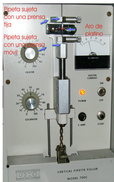
Figura 3.9: Elaboración de una micropipeta utilizando un estirador vertical.
