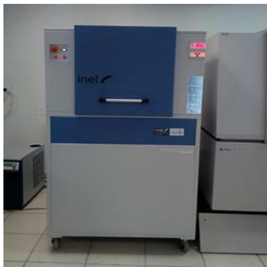
Figura 27 Difractómetro de rayos X marca Inel, modelo Equinox 2000
