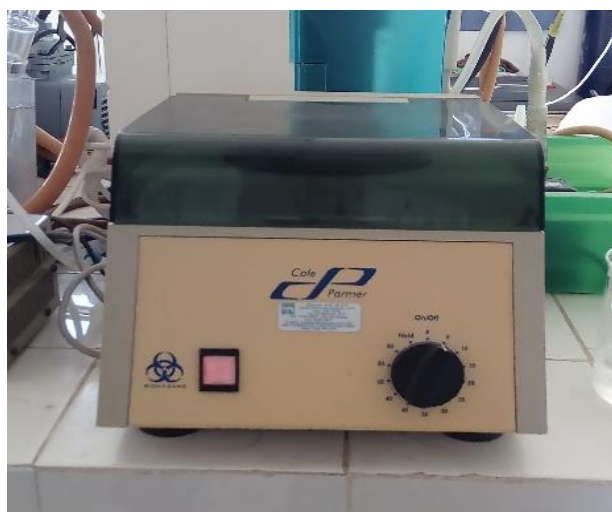
Figura 30 Centrifuga cole-palmer 17250-10, 3400 rpm
