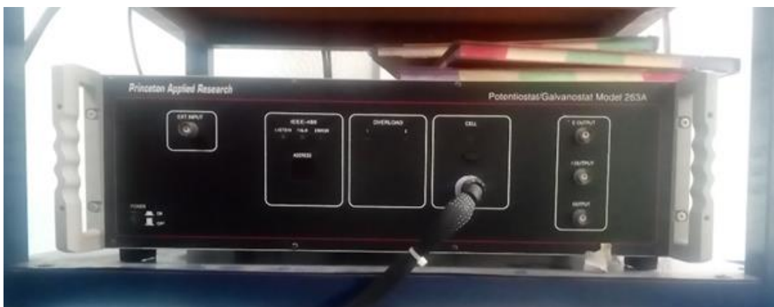
Figura 26 Potenciostato, galvanostato modelo PAR 263A
