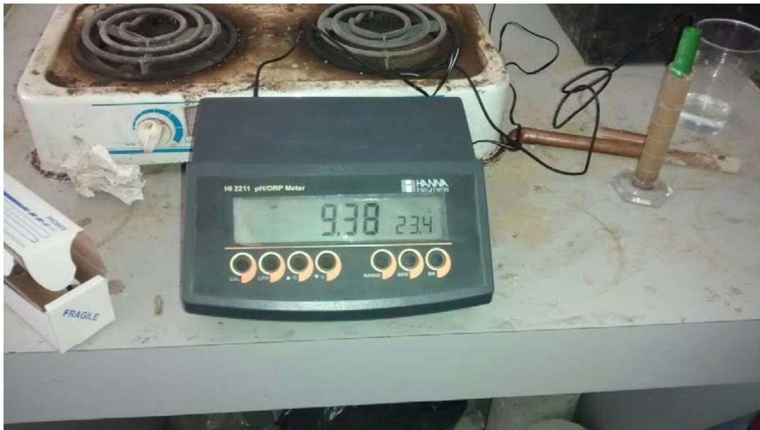
Figura 3. 4 Lectura del pH clasificado como 9 en una muestra de concreto reciclado.
