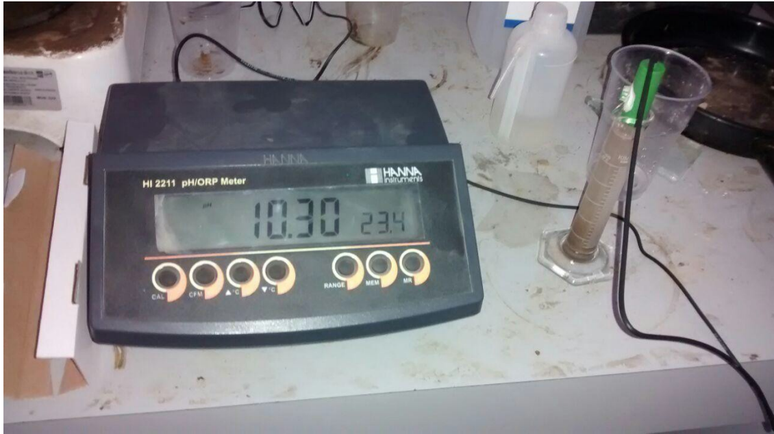
Figura 3. 5 Lectura del pH clasificado como 10 en una muestra de concreto reciclado.
