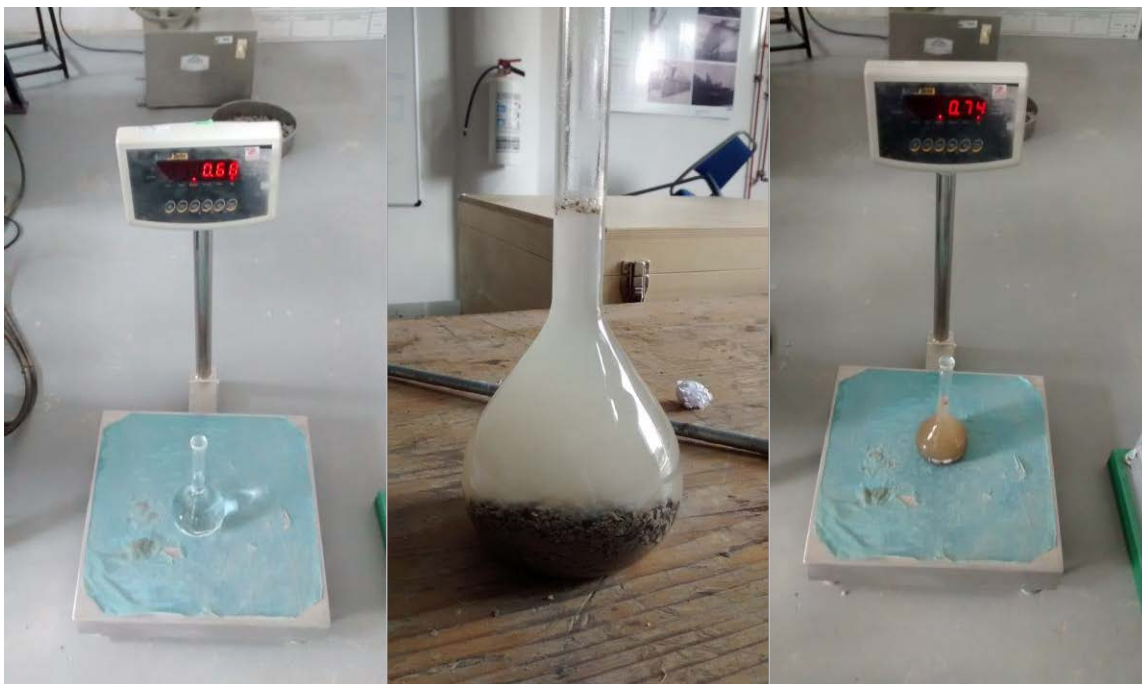
Figura 3. 9 Peso específico de solidos.
