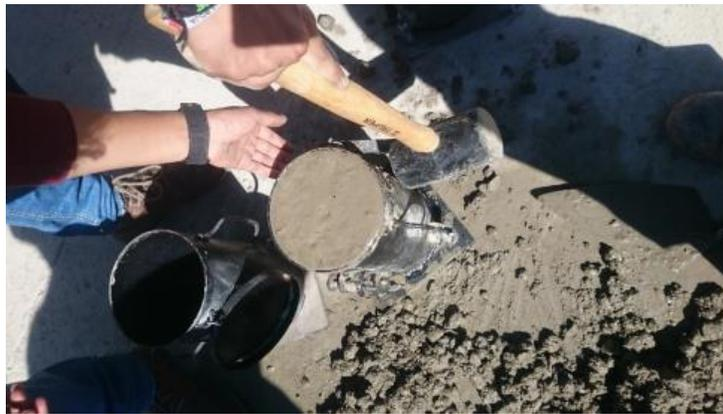
*Imagen 39. Llenado de molde metálico para elaboración de cilindro de concreto.*
