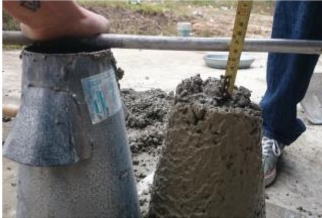
*Imagen 34. Revenimiento 2 de mezcla 50% agregados reciclados y 50% agregados naturales.*
