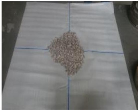
*Imagen 18. Cuarteo de agregados gruesos para análisis granulométrico*
