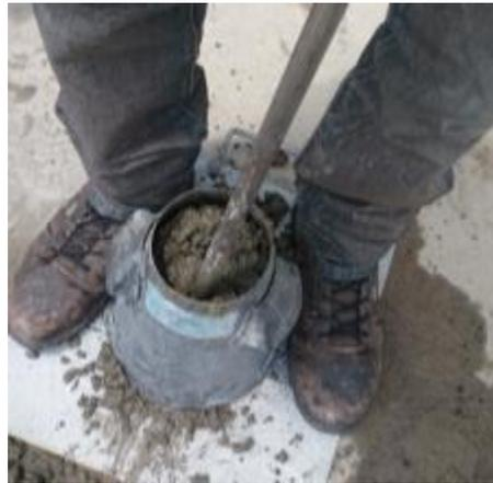
*Imagen 28. Varillado de mezcla para eliminación de vacíos.*
