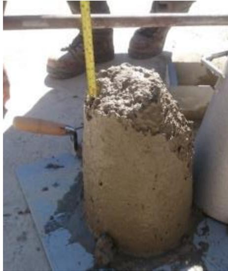
*Imagen 32. Revenimiento 3 de mezcla 100% agregados reciclados.*
