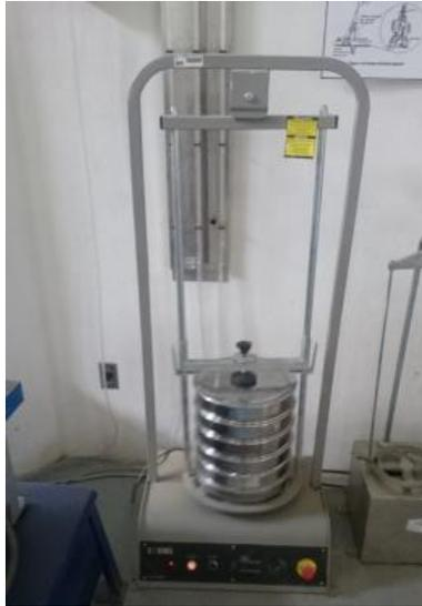
Imagen 10. Agitador mecánico tamizando muestras.
