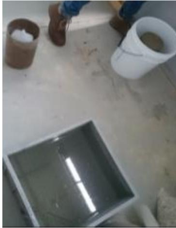
*Imagen 42. Recipiente con agua para curado de cilindros.*
