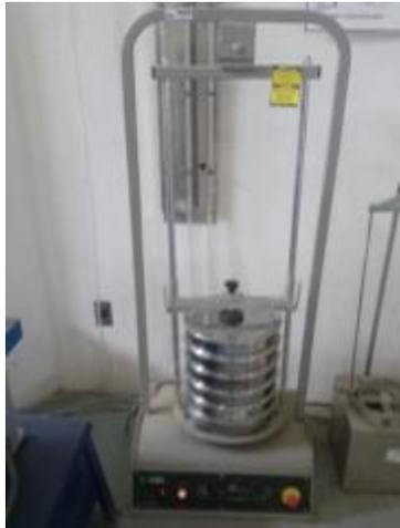
*Imagen 26. Tamizado de muestra de agregados gruesos proveniente de Bordo ponientoe para análisis granulométrico.*
