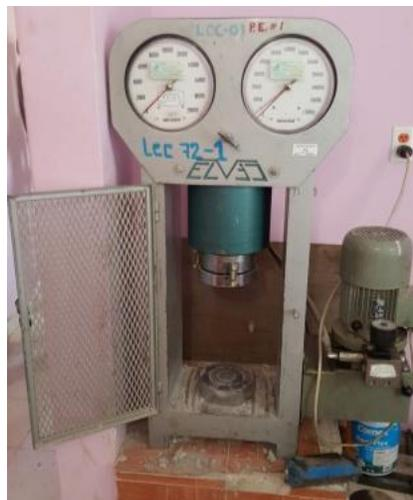
Imagen 45. Prensa de rompimiento para medir la resistencia a la compresión de los cilindros de concreto.
