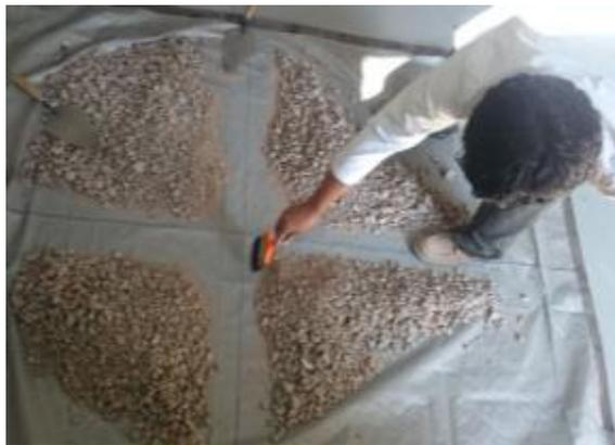
*Imagen 7. Cuarteo de muestra proveniente de Concretos Reciclados.*
