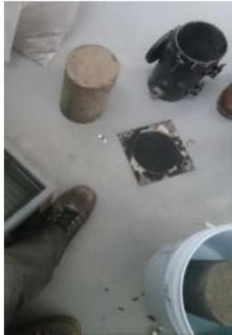
*Imagen 41. Desmolde de cilindros de concreto para su curado.*
