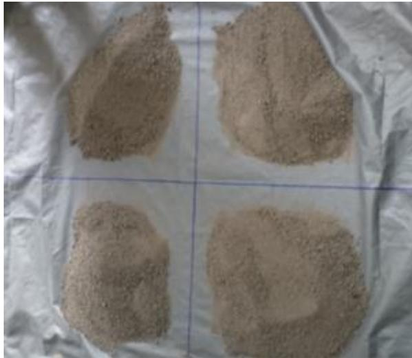
*Imagen 8. Cuarteo de muestra de finos proveniente de Concretos Reciclados.*
