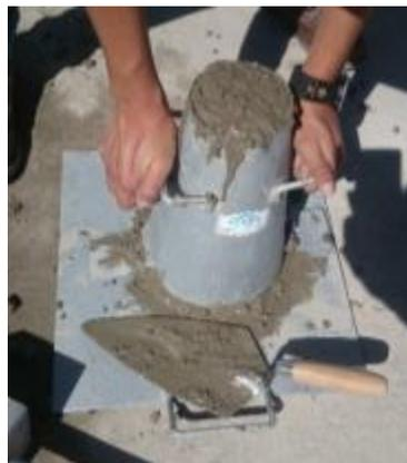
*Imagen 29. Retiro de cono de Abrams para medir revenimiento de mezcla.*
