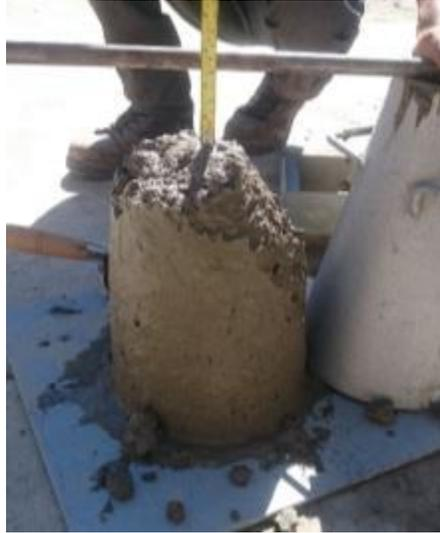
*Imagen 30. Revenimiento 1 de mezcla 100% agregados reciclados.*
