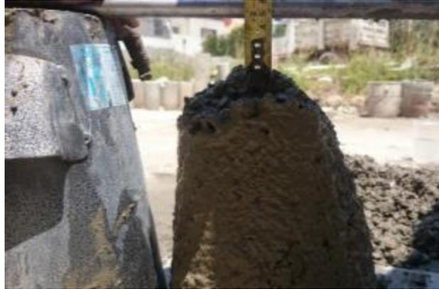
*Imagen 36. Revenimiento 1 de mezcla 30% agregados reciclados y 70% agregados naturales.*
