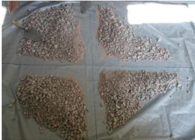
*Imagen 9. Cuarteo de muestra de gruesos proveniente de Concretos Reciclados.*
