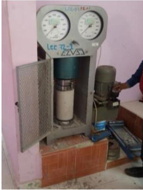
*Imagen 46. Ensayo de prueba de resistencia a la compresión de los cilindros de concreto.*
