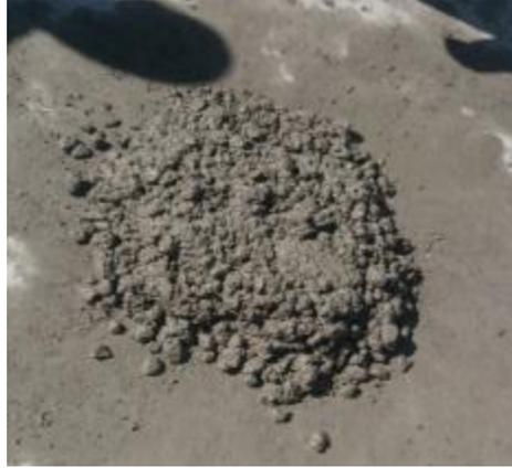
*Imagen 27. Mezcla hecha para prueba de revenimiento.*
