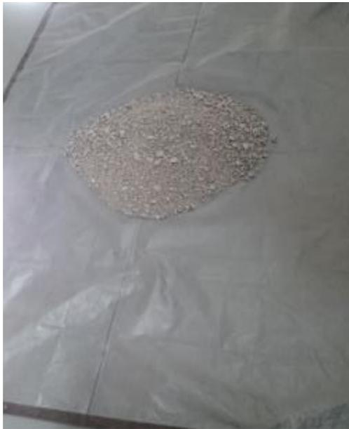
*Imagen 12. Reducción de muestra proveniente de concreto triturado in situ.*
