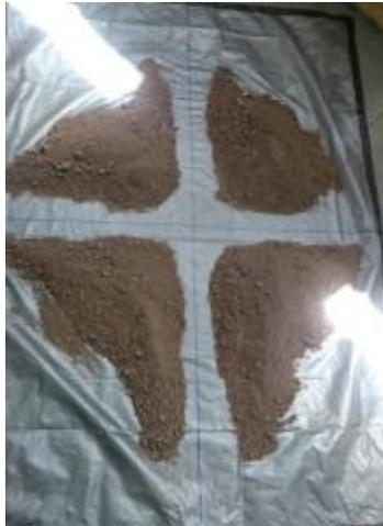
*Imagen 24. Reducción de muestra proveniente de concreto Reciclados.*
