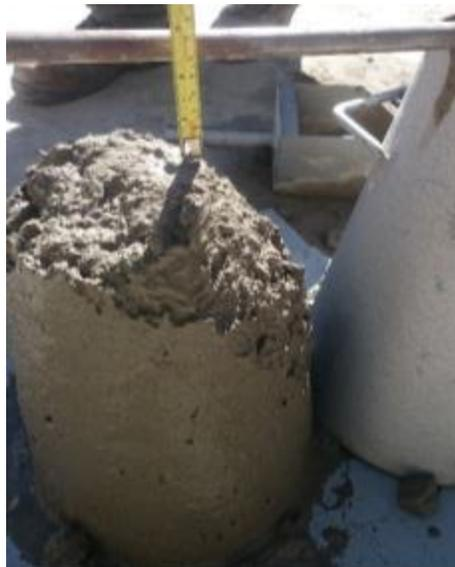
*Imagen 31. Revenimiento 2 de mezcla 100% agregados reciclados.*
