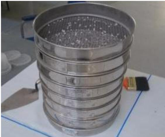
*Imagen 17. Tamizado de finos para análisis granulométrico.*
