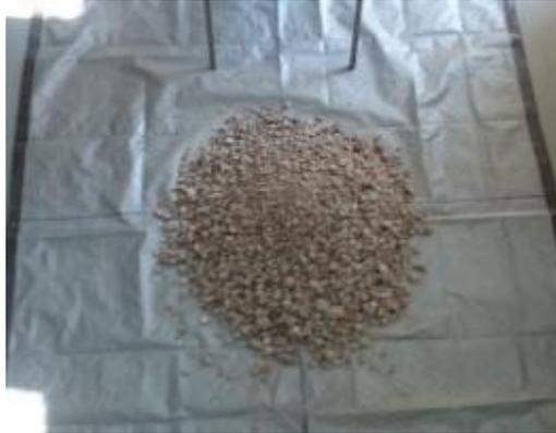
*Imagen 6. Cuarteo de muestra proveniente de Concretos Reciclados.*
