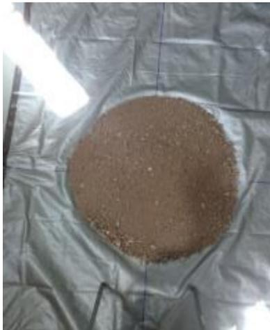
*Imagen 23. Reducción de muestra proveniente de concreto Reciclados.*
