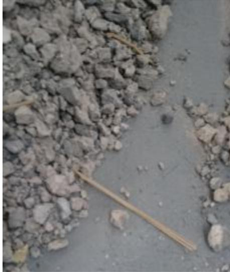
*Imagen 11. Residuos encontrados en la muestra de concreto triturado in situ. .*
