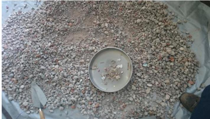
*Imagen 5. Residuos encontrados en la muestra proveniente de Concretos Reciclados.*
