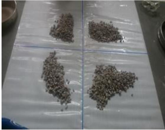
*Imagen 19. Cuarteo de agregados gruesos para análisis granulométrico.*
