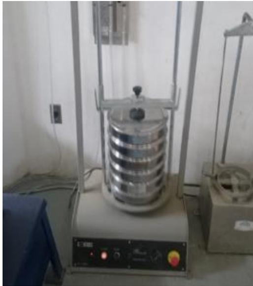
*Imagen 20. Tamizado de agregados gruesos provenientes de concreto triturado in situ en agitador mecánico.*
