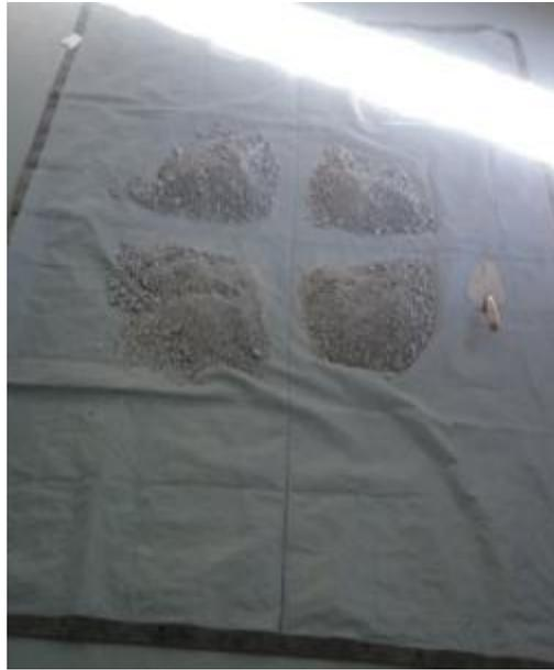
Imagen 13. Cuarteo de muestra proveniente de concreto triturado in situ.
