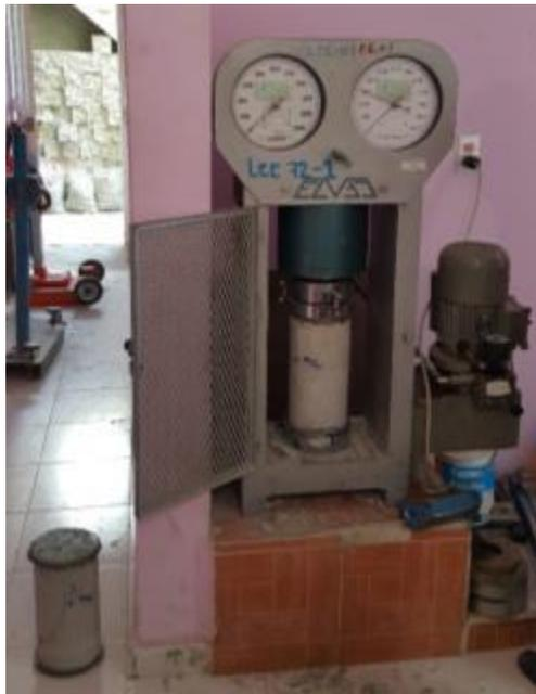
*Imagen 47. Ensayo de prueba de resistencia a la compresión de los cilindros de concreto.*
