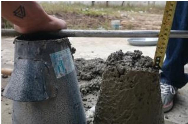
*Imagen 35. Revenimiento 3 de mezcla 50% agregados reciclados y 50% agregados naturales.*
