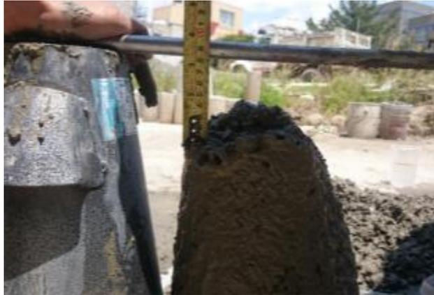
*Imagen 38. Revenimiento 3 de mezcla 30% agregados reciclados y 70% agregados naturales.*
