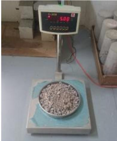
*Imagen 25. Muestra de agregado grueso proveniente de Bordo Poniente para análisis granulométrico.*
