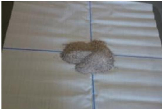
*Imagen 15. Cuarteo de agregados finos provenientes de concreto triturado in situ.*
