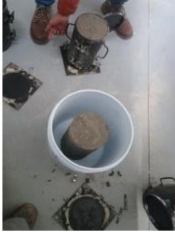
*Imagen 40. Desmolde de cilindros de concreto para su curado.*
