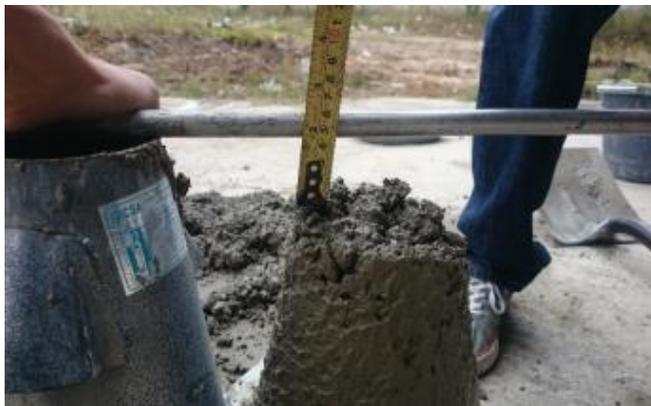
*Imagen 33. Revenimiento 1 de mezcla 50% agregados reciclados y 50% agregados naturales.*
