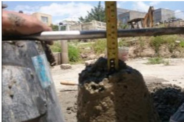
*Imagen 37. Revenimiento 2 de mezcla 30% agregados reciclados y 70% agregados naturales.*
