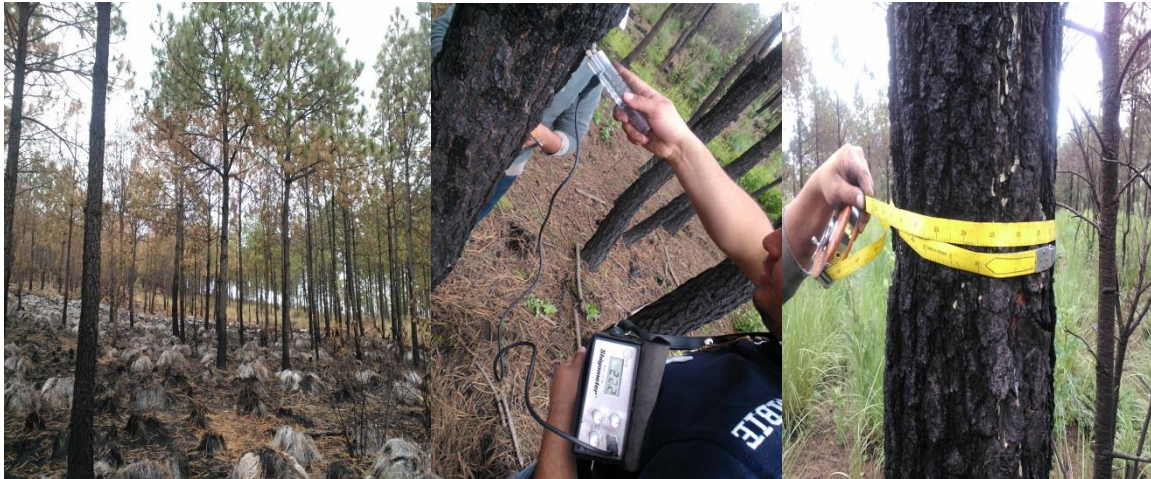
Figura 6. Evaluación de latizales de Pinus montezumae , para determinar resistencia al fuego.
