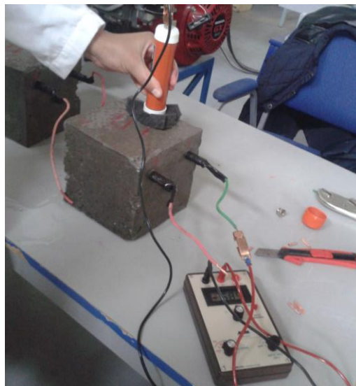
FIGURA 11. Monitoreo de potenciales de corrosión con electrodo de Cu / Cu SO 4
