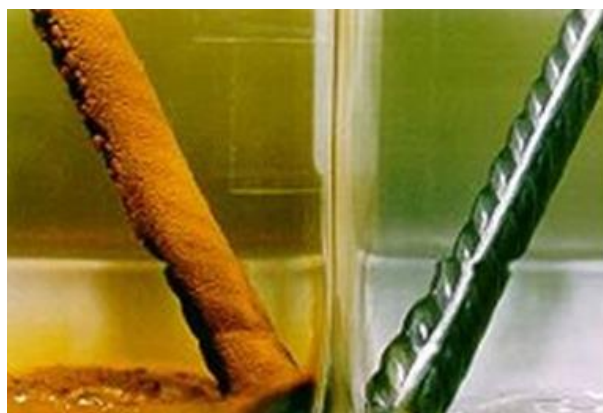
FIGURA 5. Comparación del efecto de corrosión en una varilla de acero.
