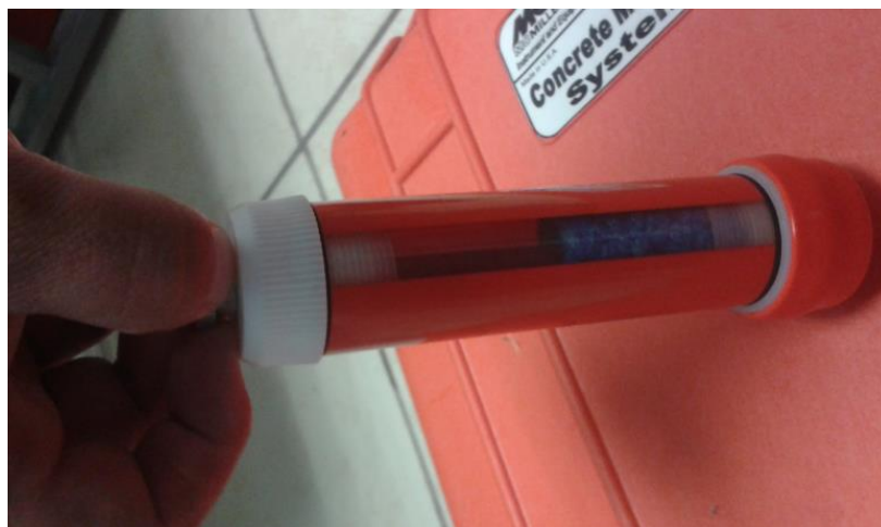
FIGURA 9. Electrodo de referencia \text{Cu}/\text{CuSO}_4
