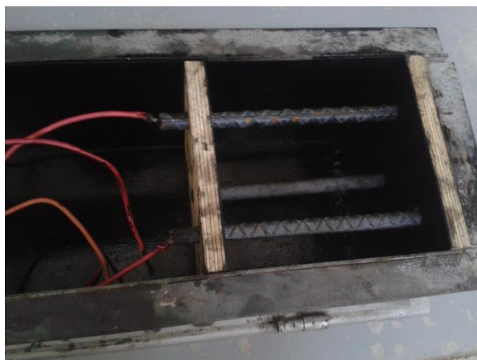
FIGURA 25. Acomodo de las varillas de acero y la barra de grafito para los especímenes.
