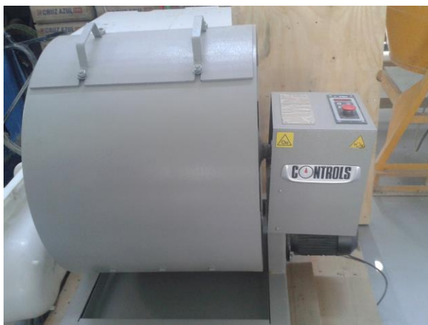
FIGURA 22. Proceso de pulverización mediante la máquina de desgaste de los Ángeles.
