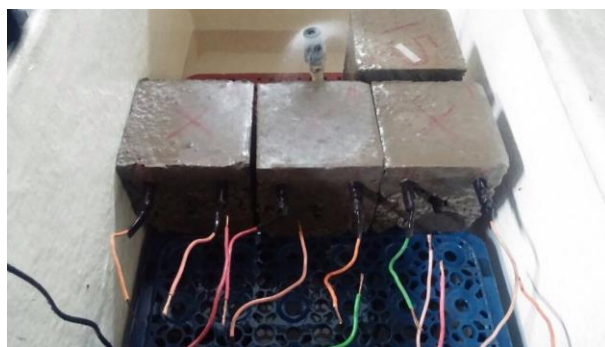
FIGURA 31. Especímenes dentro de la Cámara de aspersion de cloruros
