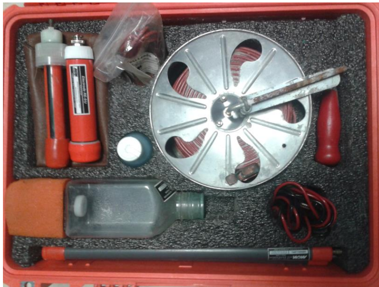
FIGURA 10. Instrumentos y accesorios empleados para el monitoreo de potenciales de corrosión.
