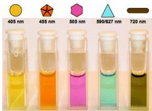
Figura 1.10 Morfología, color y máximo de absorción en UV-vis de AgNPs [31].
