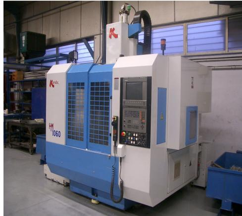
Figura 2.3: Ejemplo de automatización programable: Máquina Fresadora controlada por control numérico
