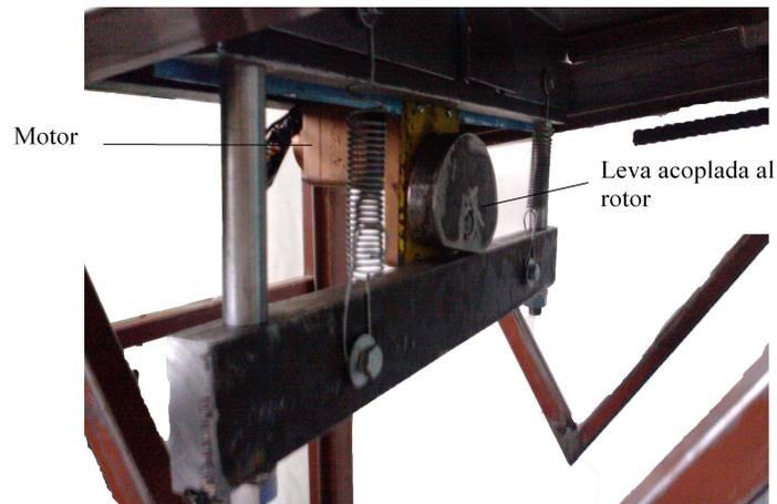
Figura 5.4: Leva acoplada al rotor del motor de CA
