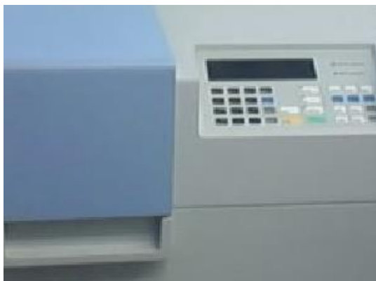
Figura 10. Polarímetro del equipo PE631136 micro cell utilizado en este trabajo.
