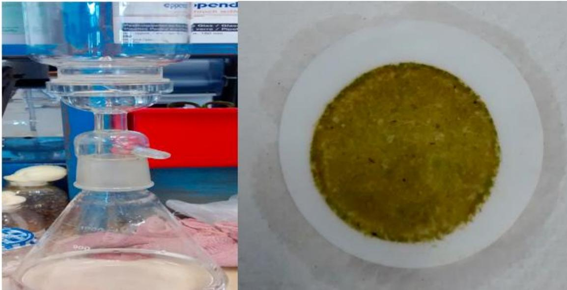
**Figura 7.** Sistema de filtración y la membrana resultante del proceso que posteriormente se utilizará para medir la clorofila.
