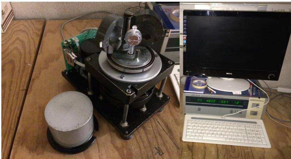
**Figura 26.** Magnetómetro de giro JR-5
