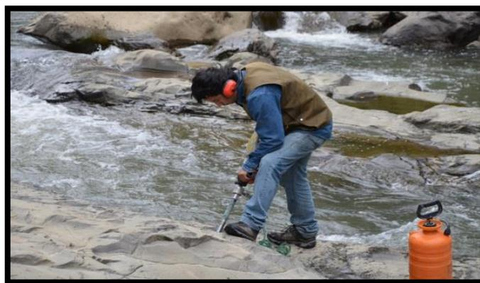
**Figura 23.** Muestreo con perforadora portátil de gasolina con diámetro de 25 cm y 6 a 12 cm de profundidad
