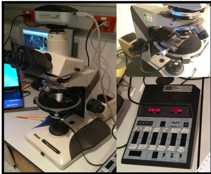
**Figura 24.** a) Microscopio petrográfico de luz transmitida marca Nikon, b) Platina del contador que permite desplazar la sección delgada en (X-Y), c) Contador electrónico con 12 canales para contar las clases modales
