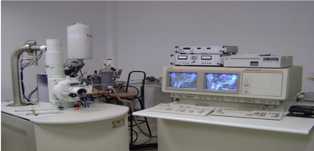
Figura 3.4. Microscopio JEOL JSM-6300 y equipado con un detector EDS.
