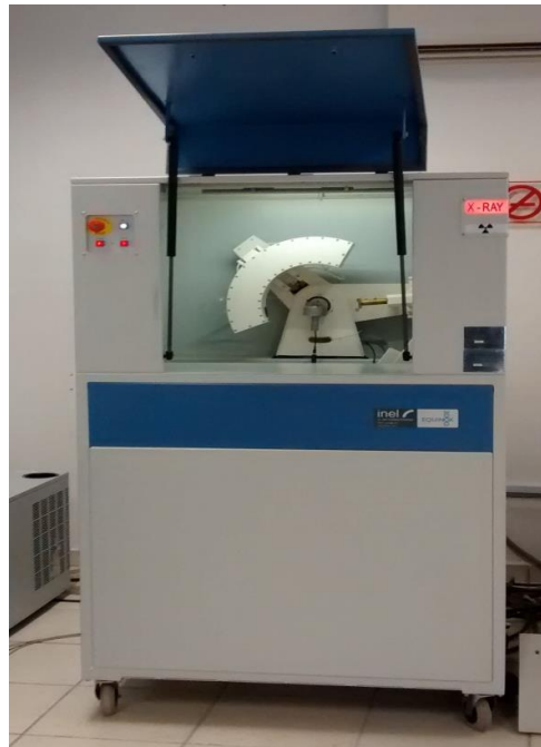
Figura 3.3. Difractómetro Marca Inel, modelo Equinox 2000
