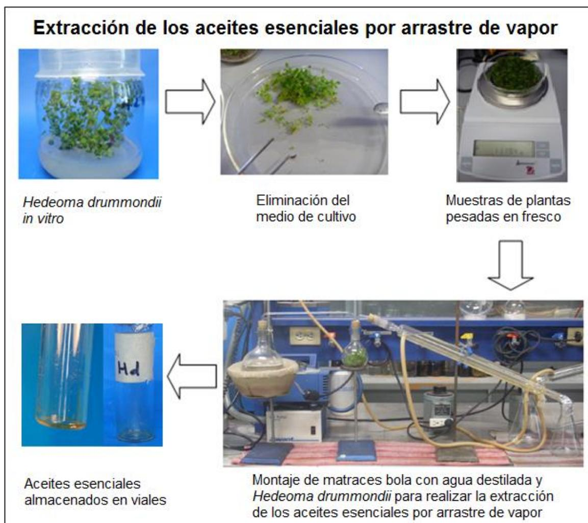
Figura 7. Esquema del proceso para realizar la extracción de aceites esenciales por arrastre de vapor. Tomado y modificado de Zamora (2012).
