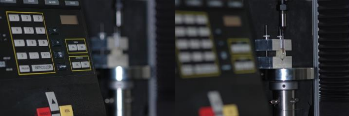
Ilustración 11 Prueba de resistencia de unión a la cizalla
