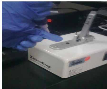
Figura 9.- Cuantificación de muestras de ADN en el equipo NanoDrop® TM 1000.
