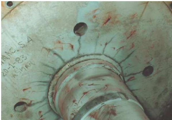
Fracturas en el material base.
