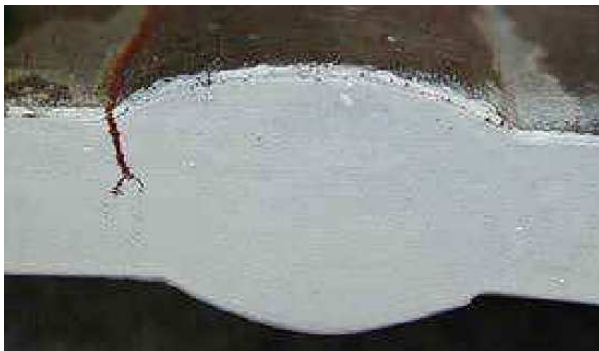
Fractura en el borde del cordón.
