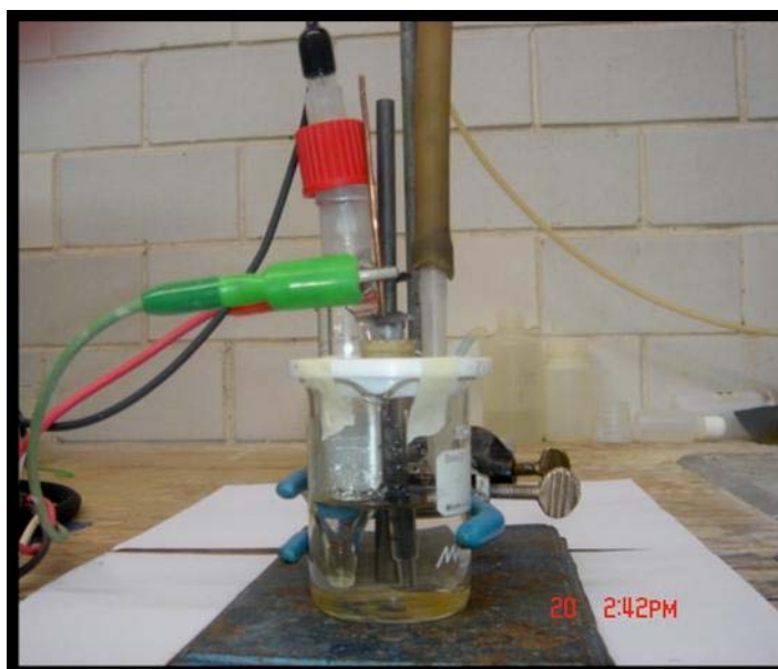
Figura 2.2. Celda electroquímica típica de tres electrodos empleada para el estudio de los EPT's.
