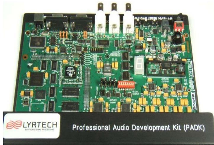
*Figura A.10 Placa física del PADK*
