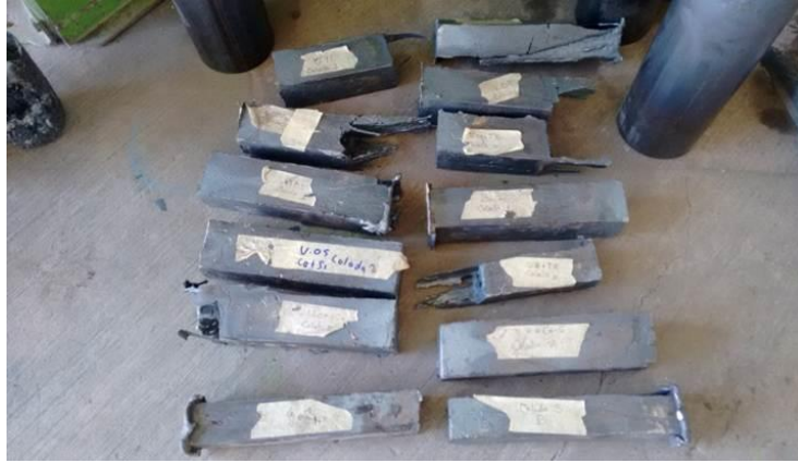
Figura 5.12. Lingotes colados que se utilizaran para obtener probetas para los diferentes ensayos mecánicos y metalográficos.
