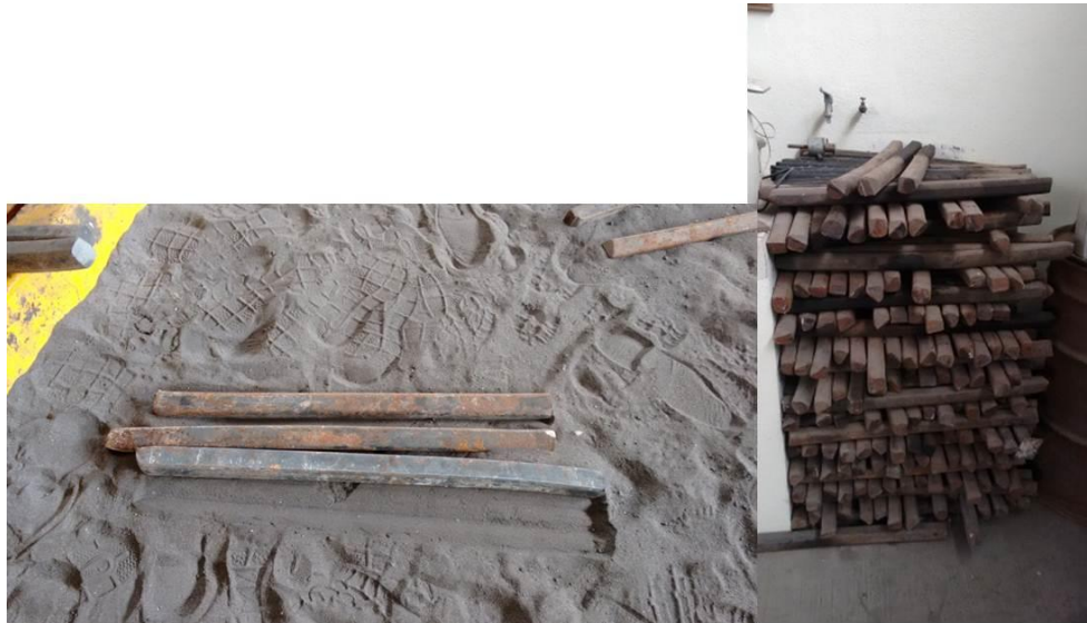
Fig. 4.6. Palanquilla de acero utilizada para la fusión de acero de medio carbono microaleado con vanadio.
