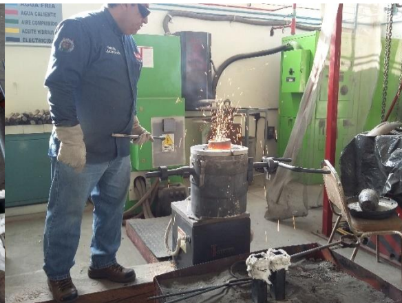
Figura 5.2. Adición de escoriador.
