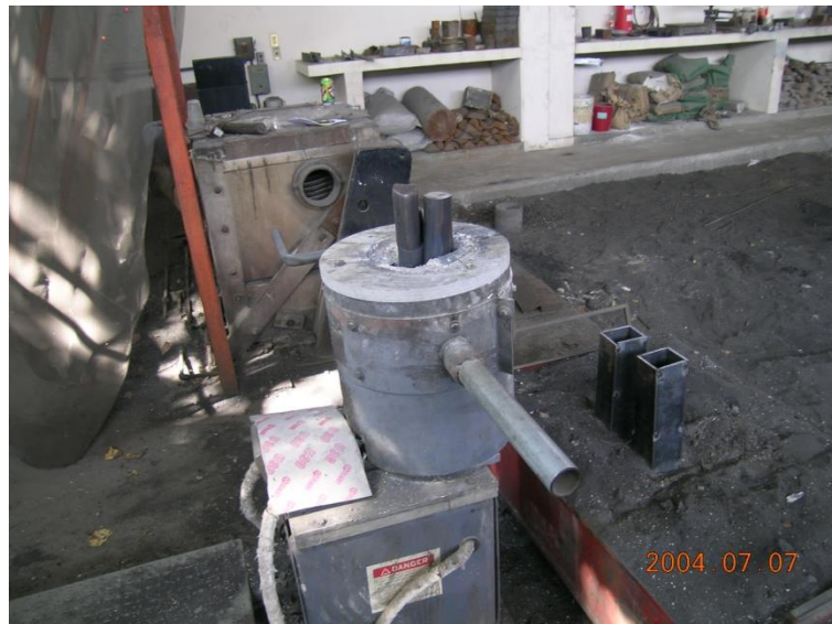
Figura 4.1. Horno de inducción con capacidad de 30 kg, utilizado para la fusión de las aleaciones de hierro.
