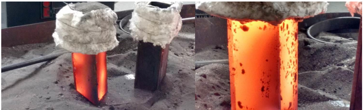
Figura 5.7. Lingotera metálica con colcha refractaria justo después del vaciado.
