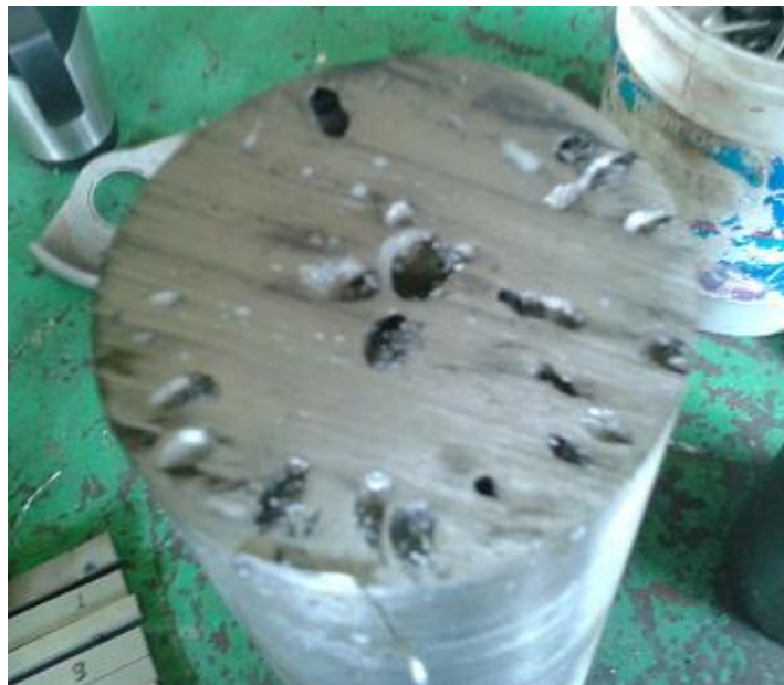
Figura 5.15. Macroporosidad debido a contaminación y humedad.
