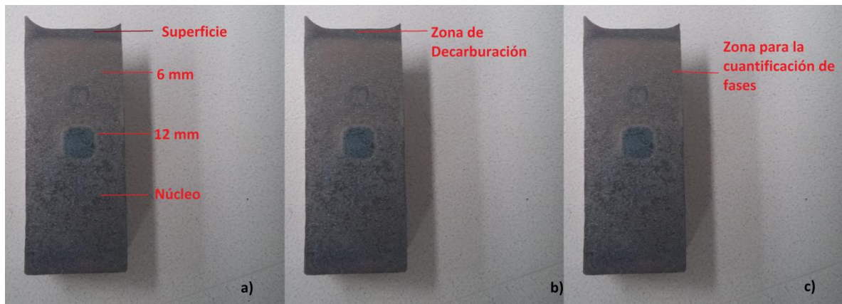
Figura 4.17. a) Zonas para la obtención de la prueba de tamaño de grano, b) Zona para la prueba de descarburación y c) Zona para la cuantificación de fases.
