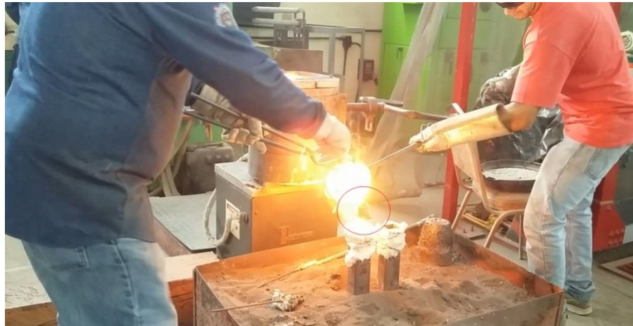
Figura 5.6. Vaciado del metal en lingoteras.
