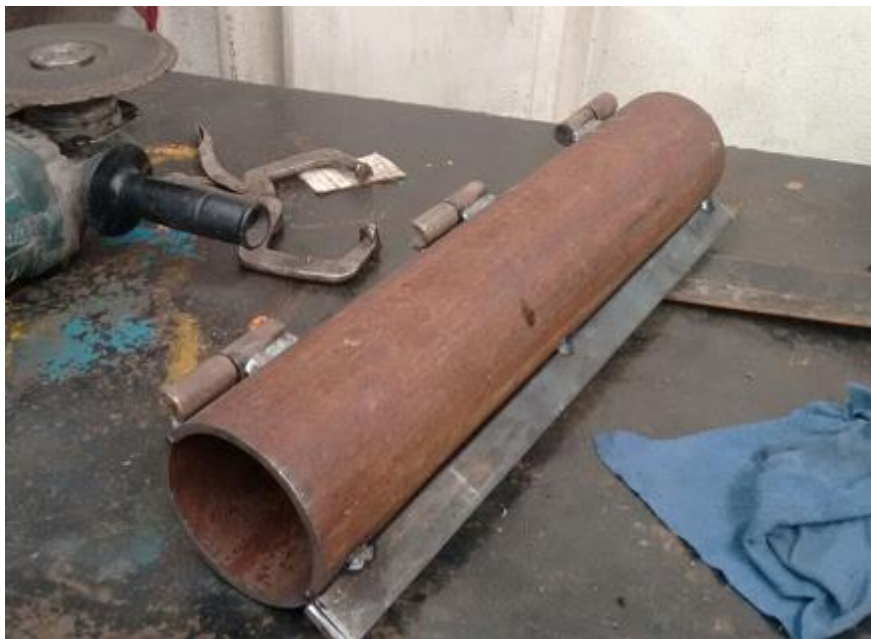
Figura 4.5. Estructura del molde cilíndrico con bisagras.
