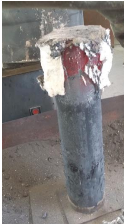
Figura 5.10. Lingote solidificado donde se observa el gradiente de temperatura debido a la presencia de la colcha cerámica en la parte superior.
