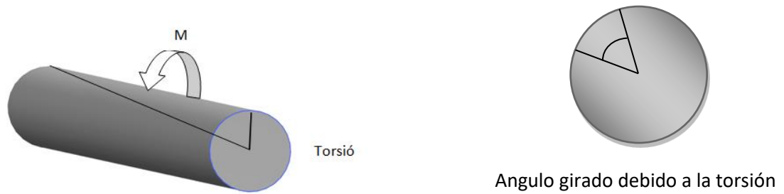
Figura 1.4. Imagen esquemática del esfuerzo de torsión en un cigüeñal.
