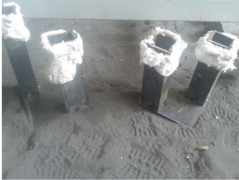
Figura 4.4. Colcha cerámica refractaria colocada en la parte superior de las lingoteras.
