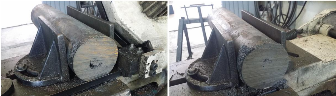
Figura 5.14. Imágenes comparativas de 2 lingotes cortados a la misma distancia donde se observa la diferencia en profundidad del rechupe.
