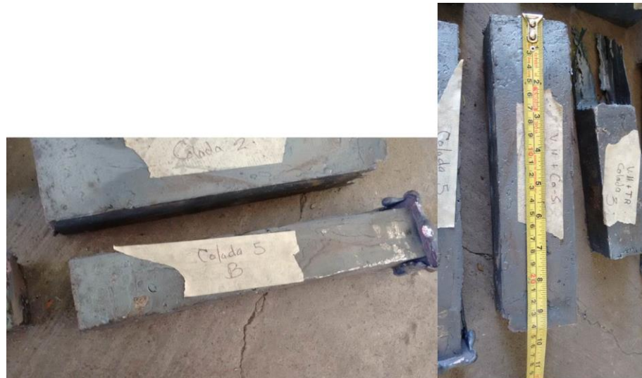
Figura 5.13. Lingotes colados que se utilizaran para obtener probetas para los diferentes ensayos mecánicos y metalográficos.
