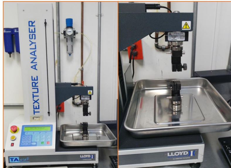
Figura 17. Máquina universal (TA plus, Lloyd), CICATA, Querétaro.
