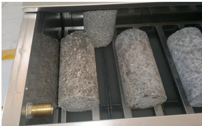
Fig. 2.12 Probetas en la cámara de curado acelerado
