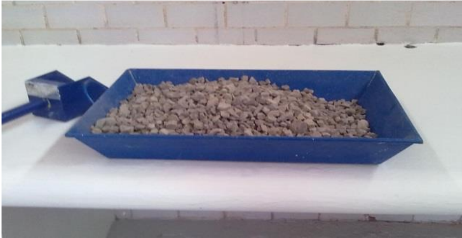
Fig. 3.6 Preparación de los agregados para el diseño de la mezcla
