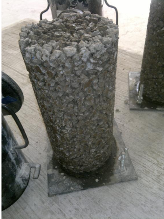
Fig. 3.13 Probetas de concreto permeable
