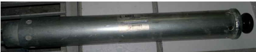
Fig. 3.15 Pisón usado para compactado de mezcla
