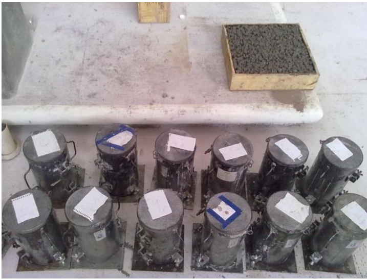
Fig. 3.24 Probetas de ensayo con mezclas de concreto poroso normal y modificadas con escoria y PET
