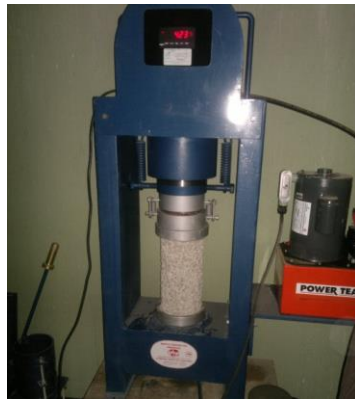
Fig. 3.28 Ensayo de probetas en prensa para prueba de resistencia a la compresión
