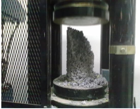
Fig. 3.29 Falla a 45° después de aplicarse una carga
