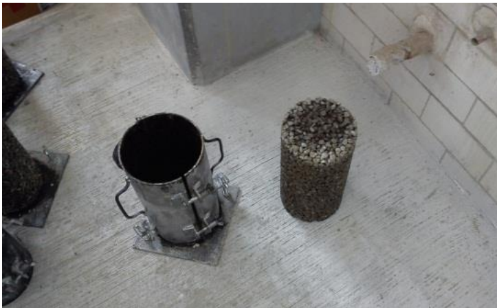
Fig. 1.11 Desmolde de concreto permeable
