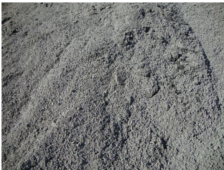
Fig. 2.3 Agregado fino (Cantera de Combia, 2013)
