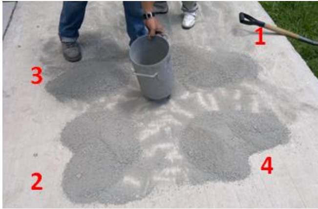
Fig. 3.1 Selección del agregado de manera que la muestra sea representativa de la pila
