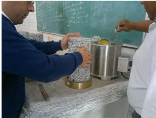
Fig. 3.27 Cabeceo de cilindros con azufre
