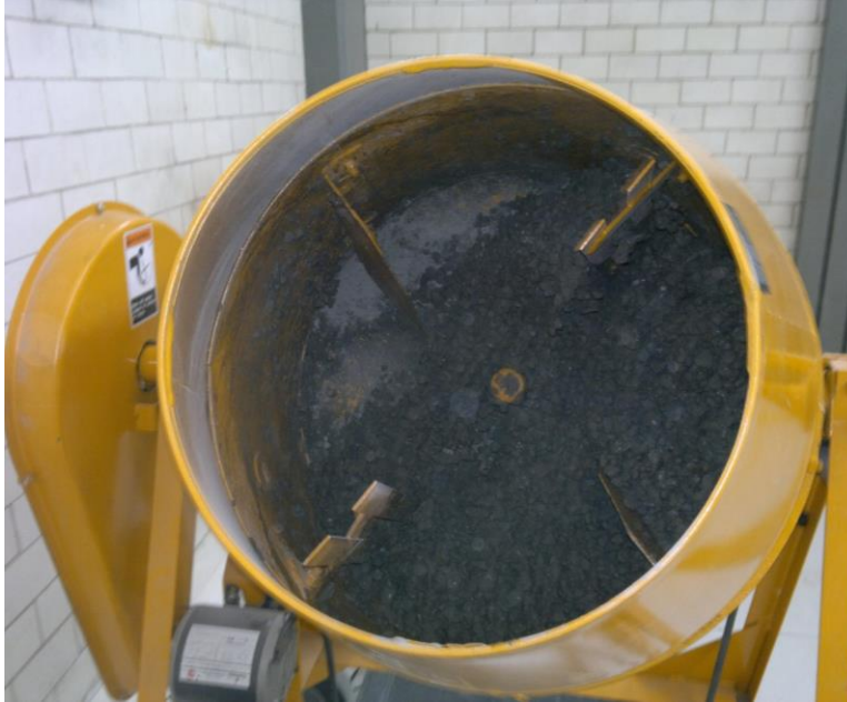
Fig. 3.9 Elaboración de mezcla utilizando revolvedora de un saco
