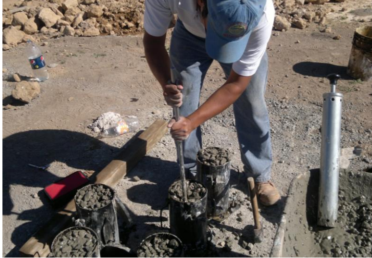
Fig. 3.10 Llenado y compactado de cilindros
